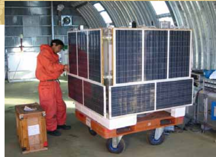
南極周回気球の放球風景(左図)と観測装置(BETS-PPB)概観。(南極昭和基地)
